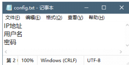
图2 config.txt文件格式
